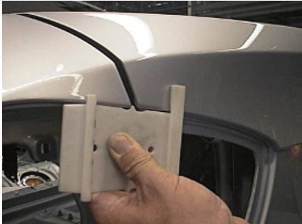
Un trabajador inspecciona el ajuste en el montaje de este vehículo utilizando un medidor impreso en 3D.
