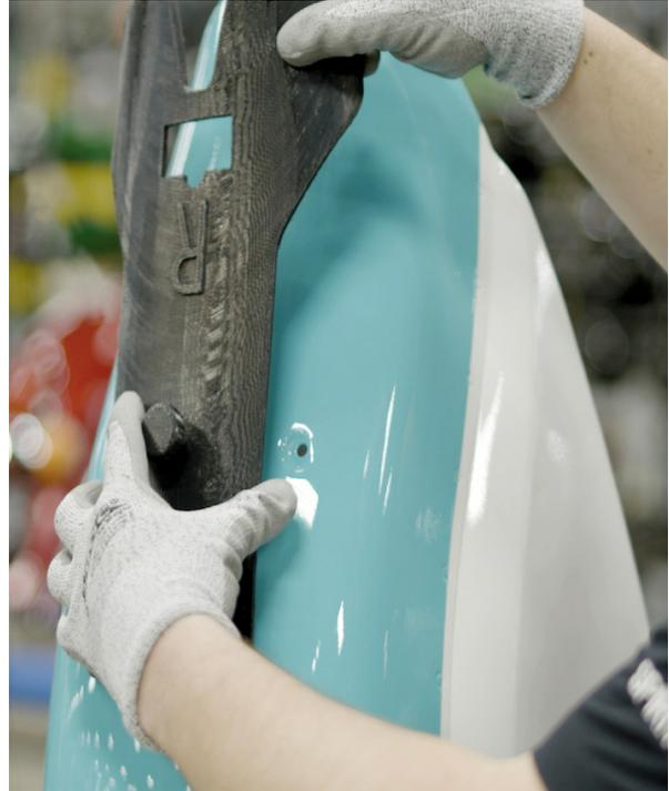
Una herramienta de montaje flexible de tacto suave fabricada con elastómero TPU 92A coloca una placa en un depósito de motocicleta sin estropear la superficie pintada.
