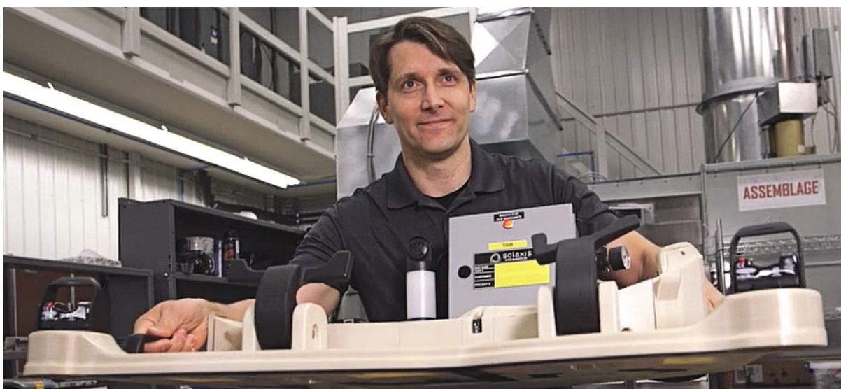
La impresión en 3D de esta guía de sellado para puertas de automóvil tuvo como resultado una reducción de peso del 80 % y una disminución del tiempo de ciclo de la tarea.
