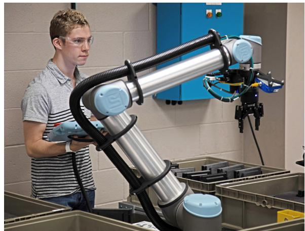
Las ligeras herramientas de extremo de brazo impresas en 3D reducen la carga en el brazo de robot y son habitualmente más rápidas y menos costosas de realizar que las equivalentes de metal.
