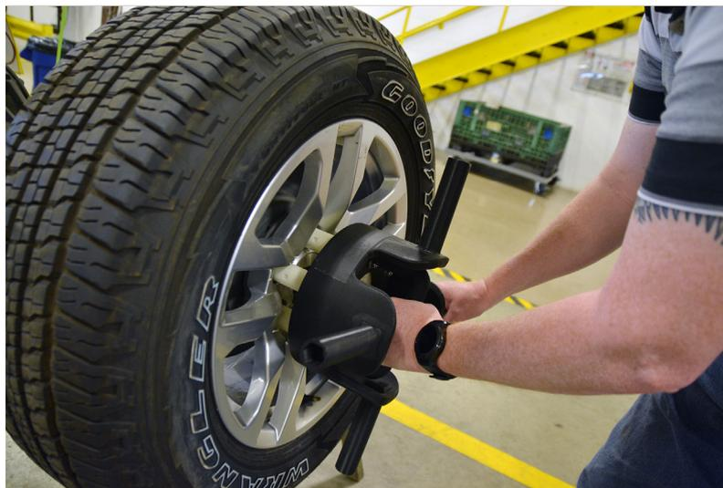
Esta herramienta de montaje impresa en 3D proporciona un medio más ligero y rápido para instalar tuercas de rueda.
