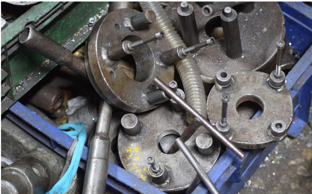
Las herramientas impresas en 3D pueden sustituir a guías de montaje típicas soldadas de metal con múltiples piezas, como estas.
