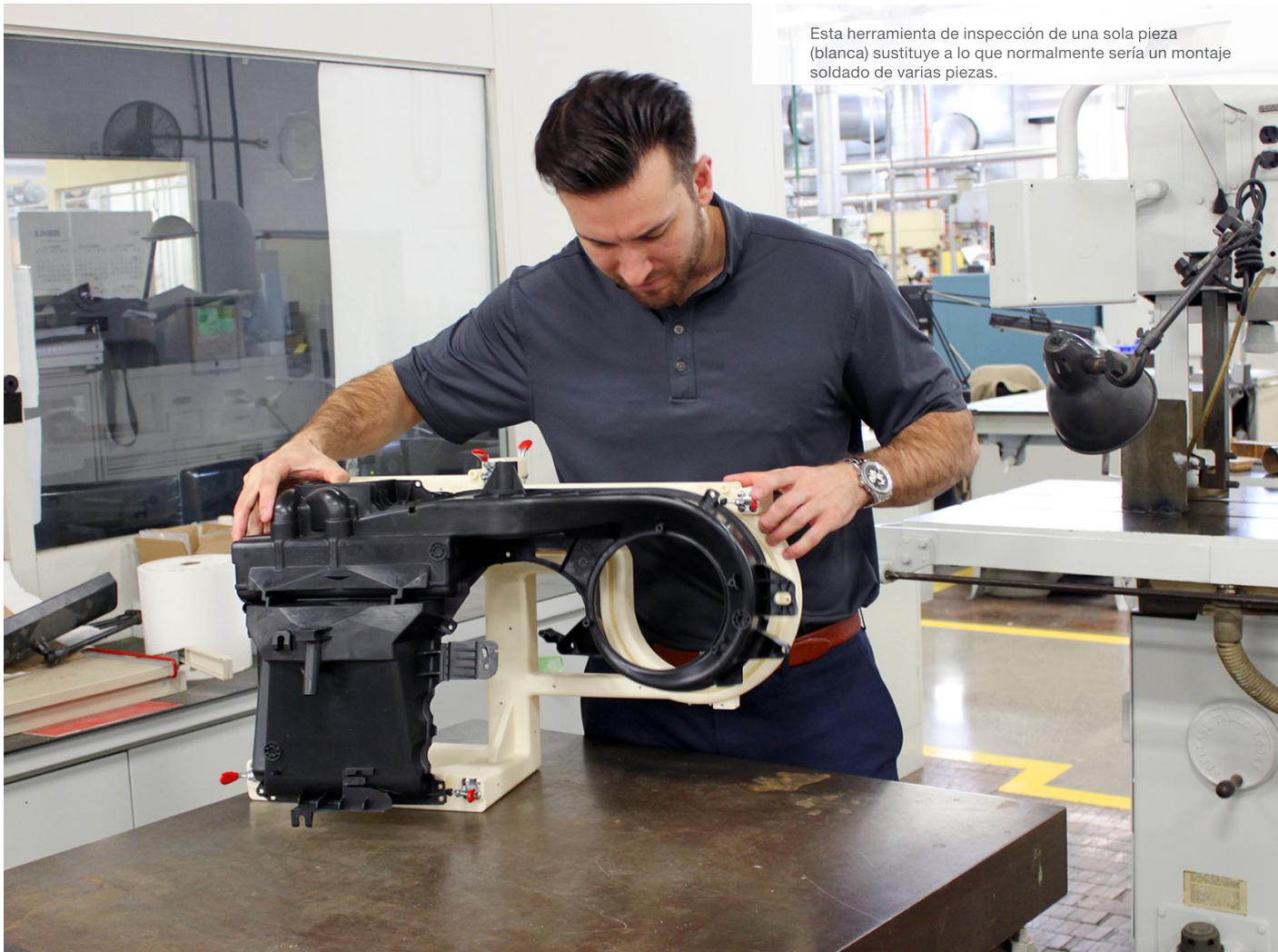
Esta herramienta de inspección de una sola pieza (blanca) sustituye a lo que normalmente sería un montaje soldado de varias piezas.
