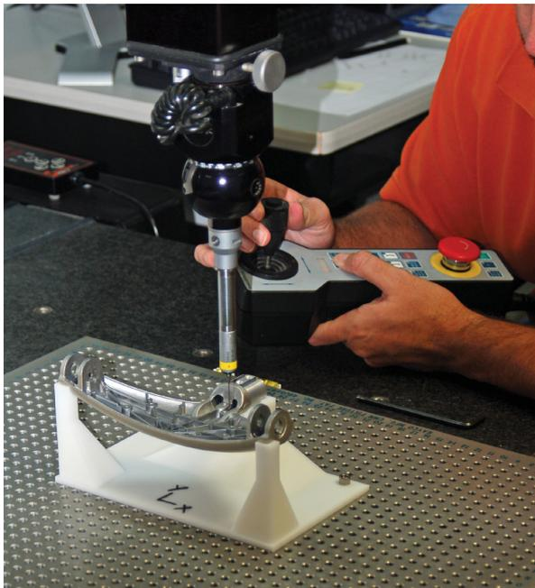
Esta fijación de inspección para CMM se creó en mucho menos tiempo del que hubiera llevado la fabricación de herramientas metálicas.
