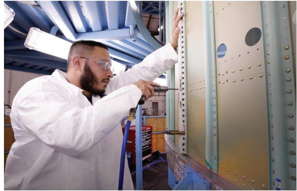
Las fijaciones de taladro realizadas de manera sencilla aceleran el proceso de montaje en este vehículo de lanzamiento espacial.
