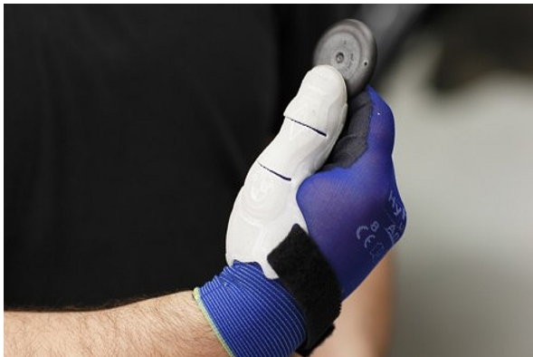
Cet outil blanc conçu pour le pouce, imprimé en 3D, assure un effet de levier et réduit la fatigue, ce qui évite les blessures provoquées par la tâche répétitive d'insertion de ces bouchons en plastique.
