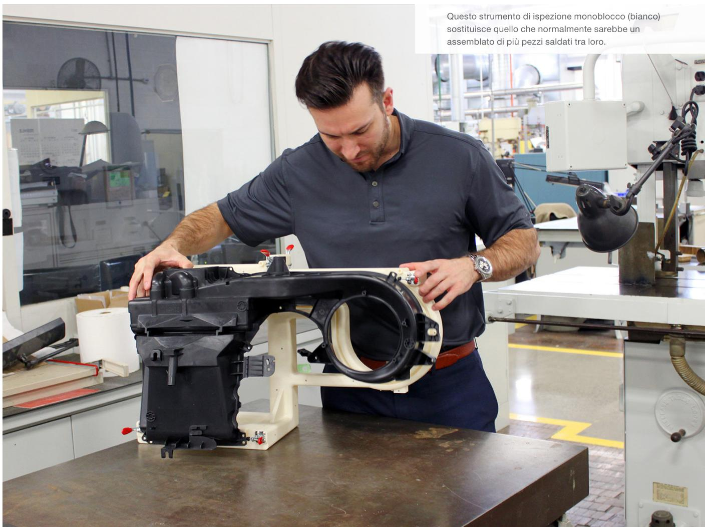
Questo strumento di ispezione monoblocco (bianco) sostituisce quello che normalmente sarebbe un assemblato di più pezzi saldati tra loro.
