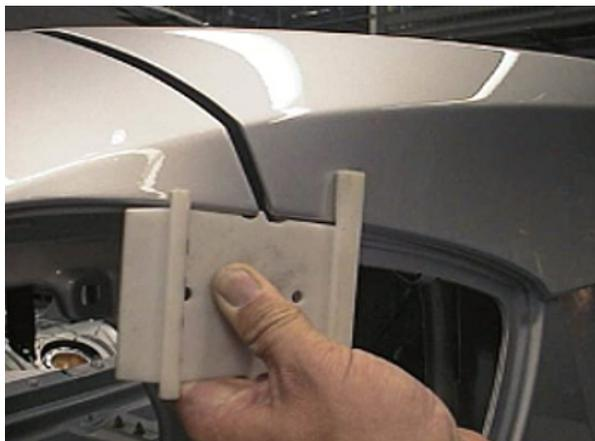
Un operaio ispeziona la precisione del montaggio su questa auto utilizzando un calibro di verifica stampato in 3D.
