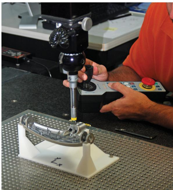
Questo dispositivo di ispezione CMM è stato creato in molto meno tempo di quello che sarebbe stato necessario per produrre lo stesso utensile in metallo.
