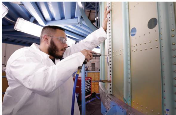
I supporti di perforazione fabbricati facilmente velocizzano il processo di assemblaggio su questo veicolo di lancio spaziale.
