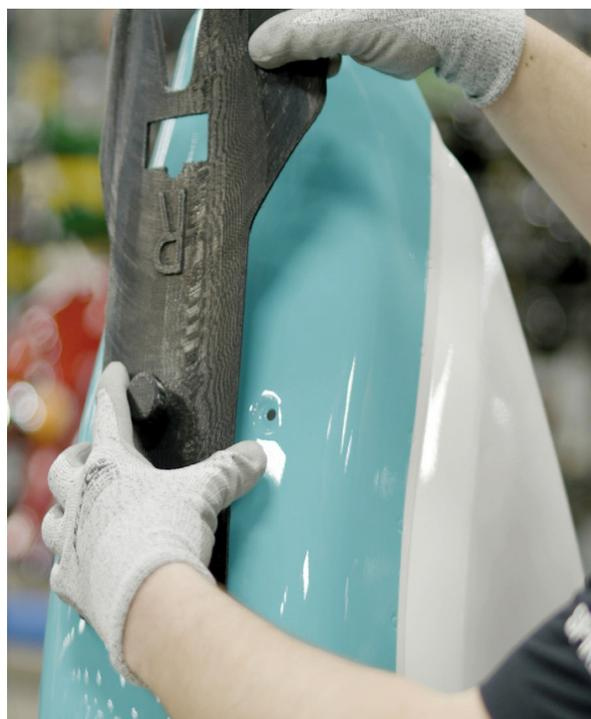
Un attrezzo di montaggio flessibile e morbido al tatto, realizzato con l'elastomero TPU 92A, posiziona un'etichetta sul serbatoio della moto senza danneggiarne la verniciatura.
