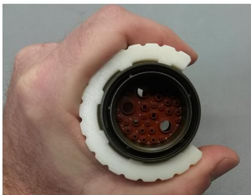
Questa pinza stampata in 3D permette al lavoratore di afferrare il connettore più comodamente, riducendone la fatica.
