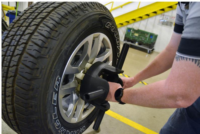
Questo strumento di assemblaggio stampato in 3D fornisce una soluzione più leggera e veloce per il montaggio dei dadi delle ruote.
